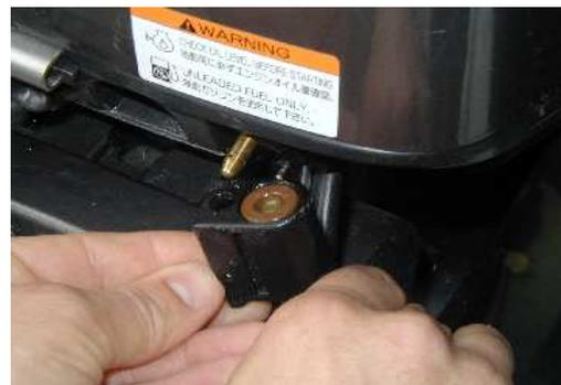
3. Amorcer l'essence à l'aide de la pompe située sur le tuyau (jusqu'à dureté)
